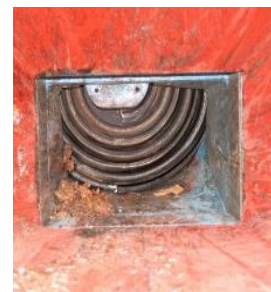
Imagine în interiorul dispozitivului unui tocător cu șurub ©greengain
