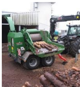
Tocător cu tambur cu alimentare prin forță hidraulică ©greengain
