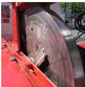
Volant cu lamele așchietoare ale tocătorului cu disc ©greengain
