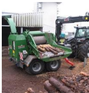
Rozdrabniacz bębnowy z hydraulicznym podawaniem wymuszonym ©greengain
