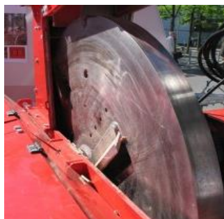
Koło zamachowe z nożem tnącym rozdrabniacza tarczowego ©greengain
