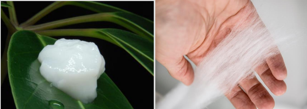
Микро фибрилизирани целулоза измешана во вода и одржливи влакнени филаменти на Spinnova © Spinnova
