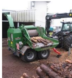
Cilindra tipa smalcinātājs ar hidraulisko piespiedu padevi © greengain
