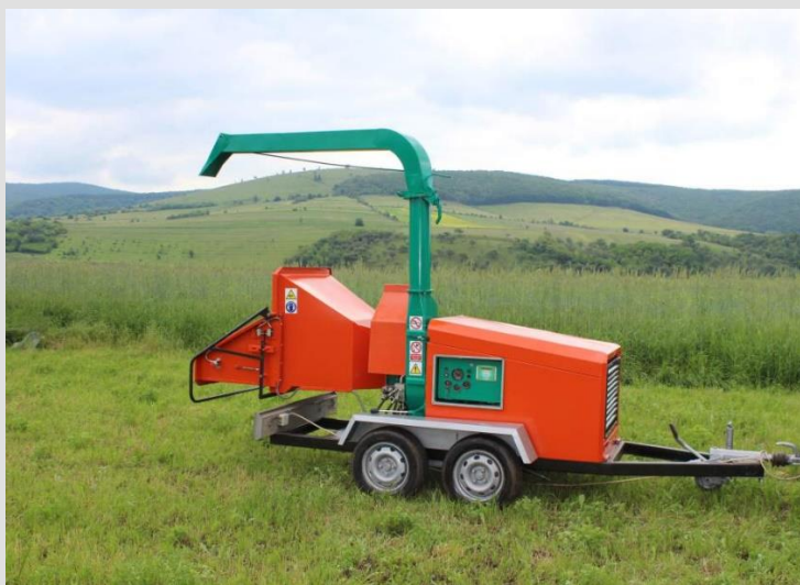
Pārvietojama koksnes šķeldošanas iekārta © IPE
