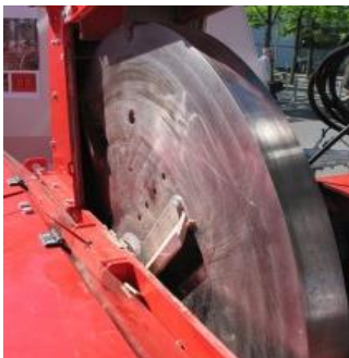
Schwungrad mit Hackmesser eines Scheibenhackers ©greengain
