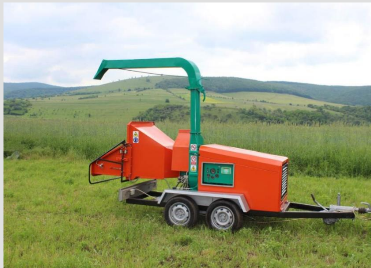
Mobile Holzhackschnitzelanlage © IPE
