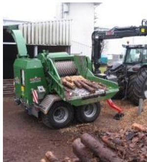
Trommelhacker mit hydraulischer Zuführung ©greengain
