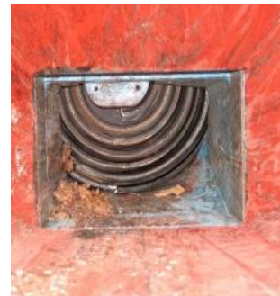
Blick in die Zerkleinerungsvorrichtung eines Schraubenhackers ©greengain
