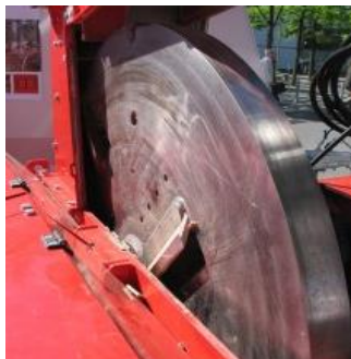
Маховик с надробяващ нож на дискова дробилка ©greengain
