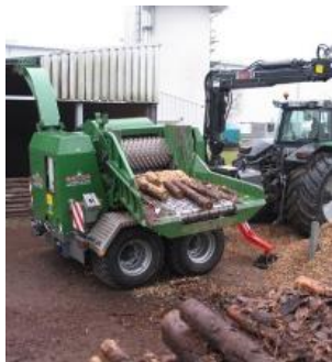
Барабанна дробилка с хидравлично силово подаване ©greengain
